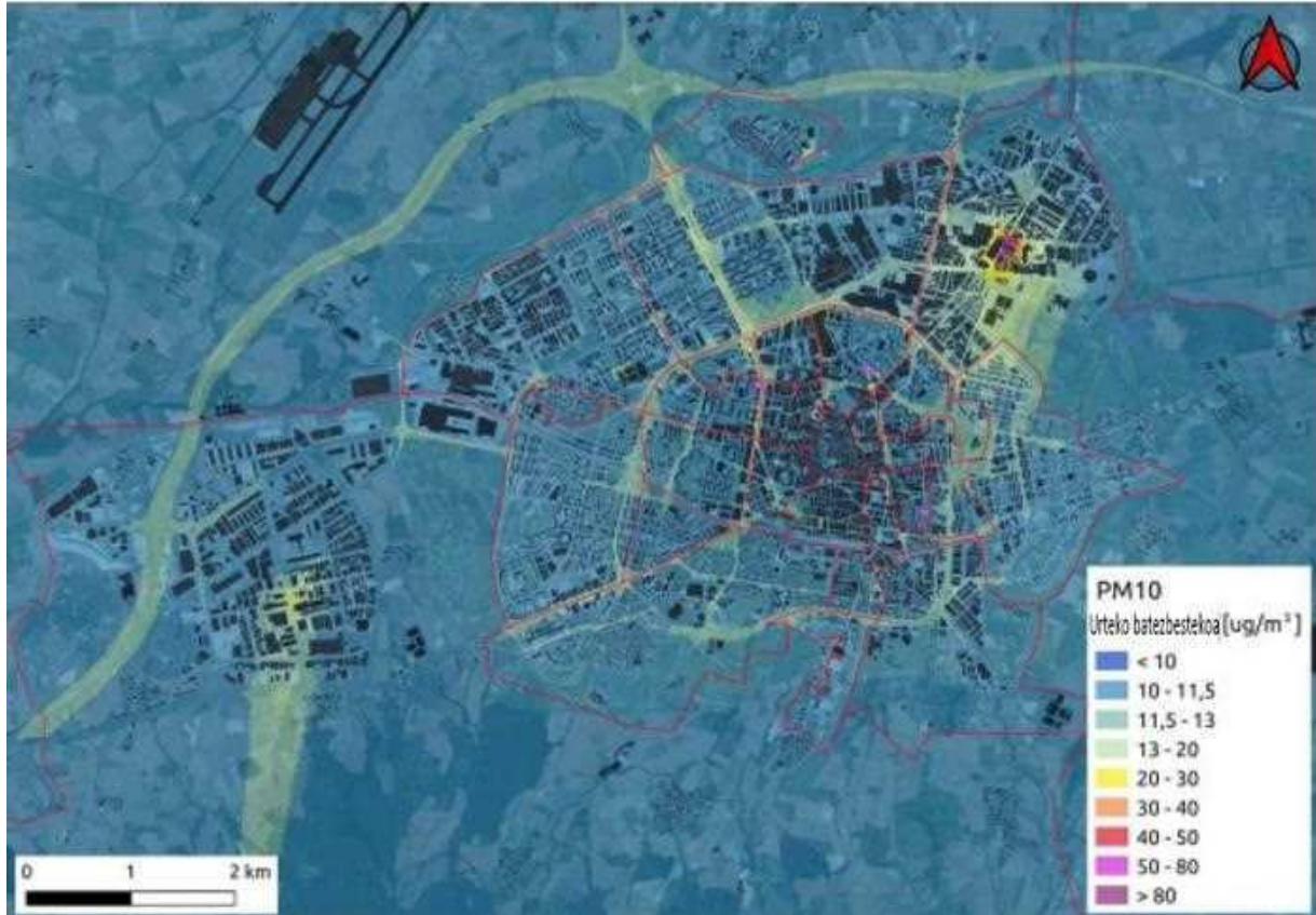
25. ilustrazioa. Gasteizko PM_{10} -en kontzentrazioaren urteko batezbestekoa 3 m-ko garaieran, \mu\text{g}/\text{m}^3 -tan, trafikoaren eta bizitegi-sektorearen, zerbitzu-sektorearen eta industria-sektorearen (BZISen) emisioen batura eta hondoa kontuan hartuta, 2017. urteko datuekin.
