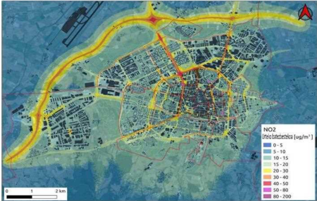
24. ilustrazioa. Gasteizko NO 2 kontzentrazioaren urteko batezbestekoa 3 m-ko garaieran, µg/m 3 -tan, trafikoaren eta bizitegi-sektorearen, zerbitzu-sektorearen eta industria-sektorearen (BZIsen) emisioen batura eta hondoa kontuan hartuta, 2017. urteko datuekin.
