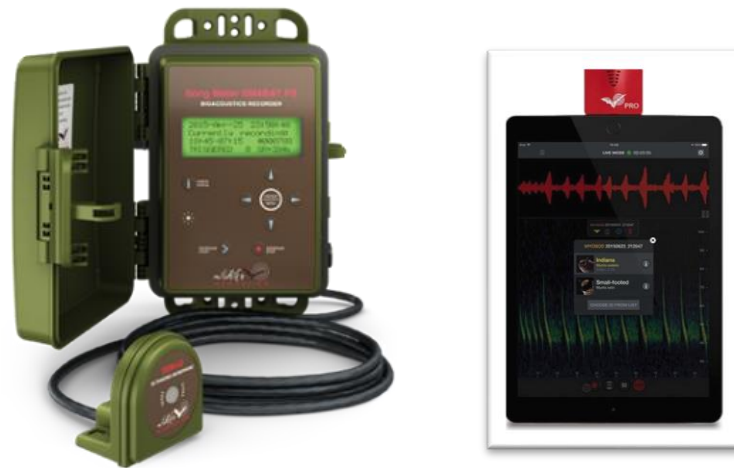
Figura 2. Izquierda: grabadora de ultrasonidos SM 4 BAT Full Spectrum (Wildlife Acoustics), utilizada en los puntos de muestreo. Derecha: micrófono Echo Meter Touch 2 Pro (Wildlife Acoustics) conectado a una Tablet (iPad, Apple) utilizado en los transectos nocturnos.
