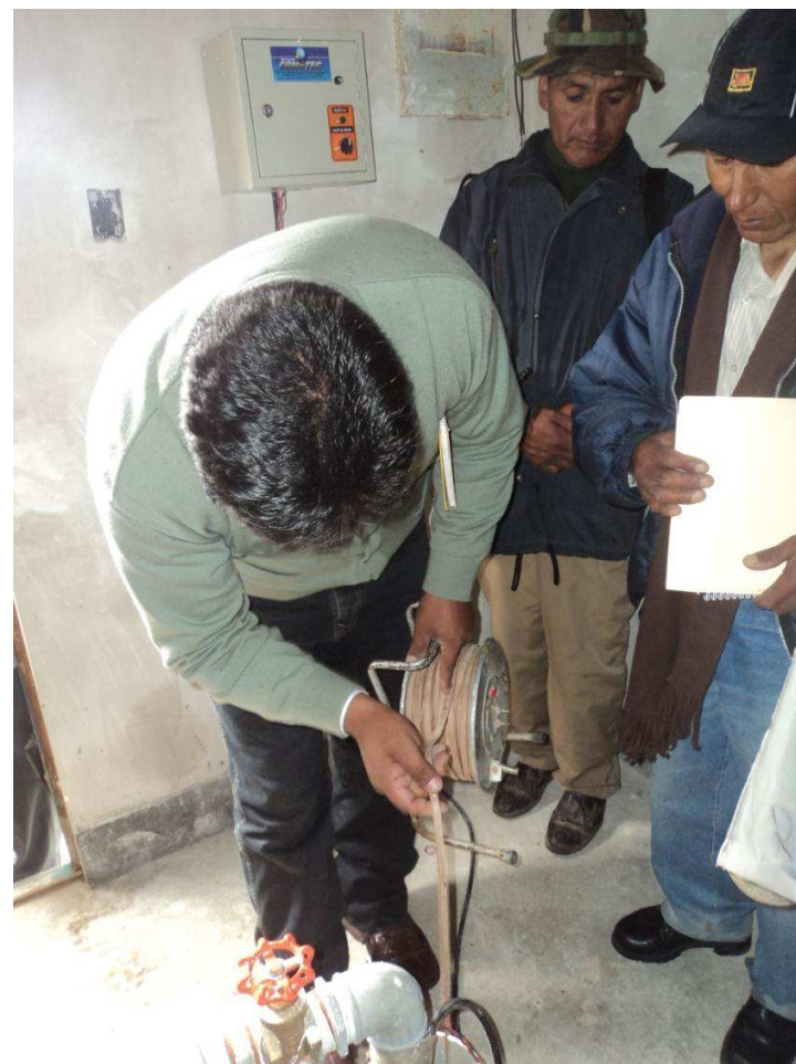
Fotografía N° 03: Verificando el nivel estático del agua y la profundidad del pozo.
