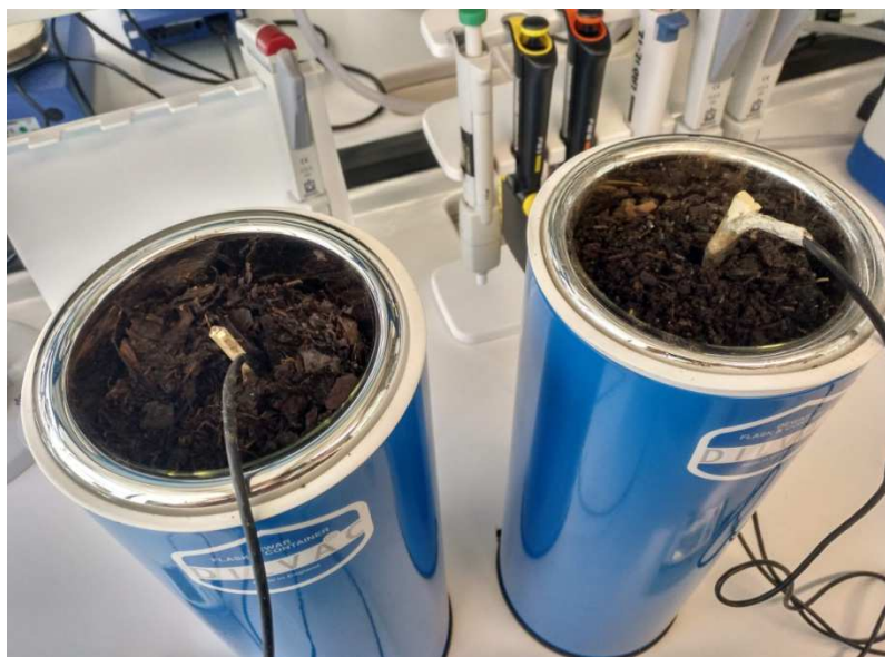
8.Irudia: Dewar ontziak konpost laginez beteta eta sonda termikoak erregistratzaileari konektaturik. Iturria: propioa.
