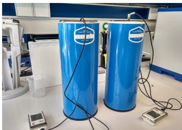
7. Irudia: Dewar ontziak konpost laginez beteta eta sonda termikoak erregistratzaileari konektaturik. Iturria: propioa.
